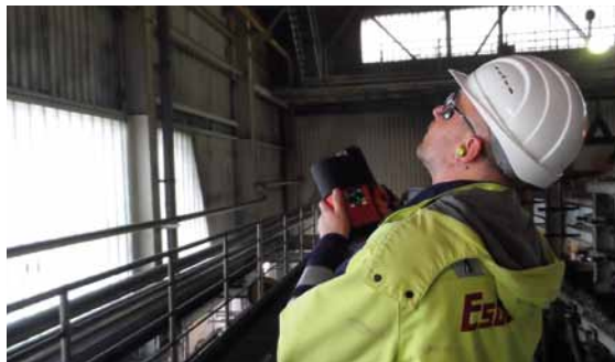
Bild 4 Messung an schwer zugänglicher Gasleitung in Deckennähe
