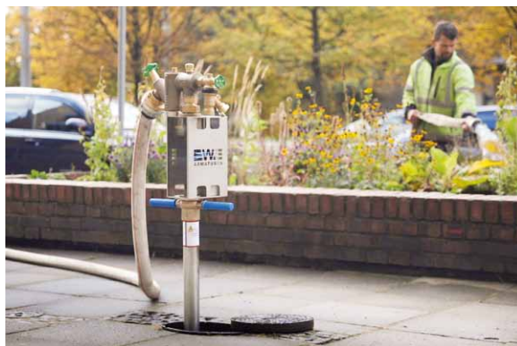
Links: Digitales Standrohr in der mobilen Wasserversorgung. Rechts: Browserbasierte Webapplikation zur Verwaltung und Überwachung der digitalen Standrohre (ewe-srv.de)
