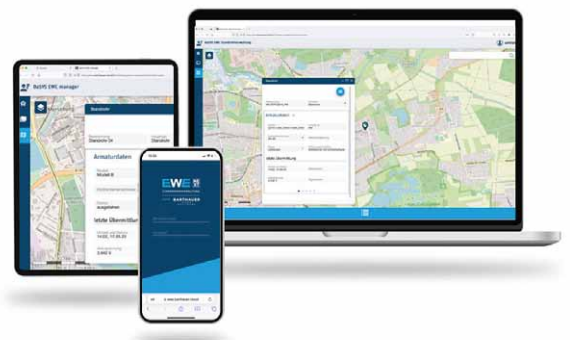
Links: Digitales Standrohr in der mobilen Wasserversorgung. Rechts: Browserbasierte Webapplikation zur Verwaltung und Überwachung der digitalen Standrohre (ewe-srv.de)
